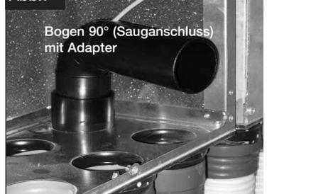
8. Staubsauger-Rohr mit entsprechender Dichtung am hinteren Ende des Sauganschlusses (Bogen 90°) einsetzen (Abb. 8).
