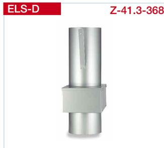
**Brandschutz-Deckenschott ELS-D gegen Brandübertragung in andere Geschosse.** Einbau in Lüftungshauptleitung entspr. DIN 18017 K90. Ohne Wartungsauflagen. Für Lüftungs- oder gemischt (auch mit brennbaren Leitungen) belegte Installationsschächte, die nur einer Verklei-
