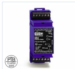
Bei Erreichen der Nenn-Ansprechtemperatur eines Kaltleiters fällt das eingebaute Relais ab. Störung wird durch eingebaute Leuchtdiode angezeigt. Wiedereinbetriebnahme durch Drücken der Taste „Reset“ oder über extern anschließbaren Schalter. Kunststoffgehäuse für Schaltschrankinstallation auf Tragschiene nach DIN EN 60715.
