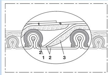
Hochtemperaturschlauch, Klemmprofilschlauch, mehrlagig, isolierend, geeignet für leichten Überdruck (bis +700°C)
