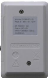
2. Schrauben auf der Rückseite des Datenloggers lösen.
