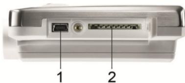
4. USB-Kabel in den Mini-USB-Anschluss (1) schieben.
