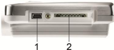
5. USB-Kabel in den Mini-USB-Anschluss (1) schieben.
