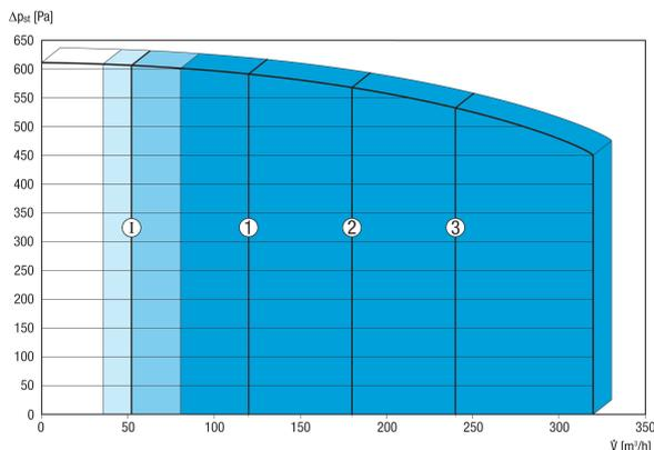
Die abgebildeten Zahlen zeigen die voreingestellten Lüftungsstufen ("Werkseinstellungen").
