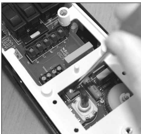
Abb. 2d: Justierpotentiometer zur Einstellung der Mindestdrehzahl
