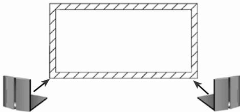
1. Winkelschutz an den Bodenkanten des Lüftungskanals anbringen
