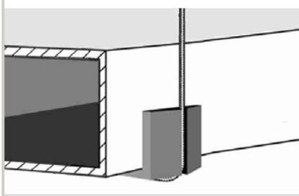
2. Seil durch die Rillen des Winkelschutzes ziehen
