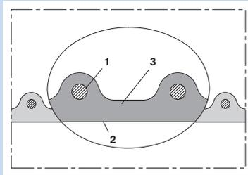
Antistatischer Lebensmittelschlauch und Pharmschlauch, schwer, Edelstahlbraht(INOX)
