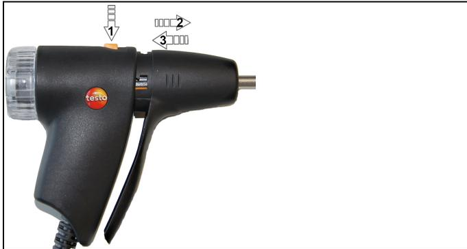
1. Taste an der Oberseite des Sondengriffs betätigen (1) und Sondenmodul abnehmen (2).
