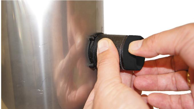
2. Sondenhalterung durch Drehen des Fixierungsring im Uhrzeigersinn am Abgaskanal befestigen.
