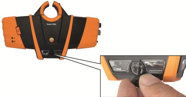
1. Kondensatauslass am Kondensatbehälter öffnen.
