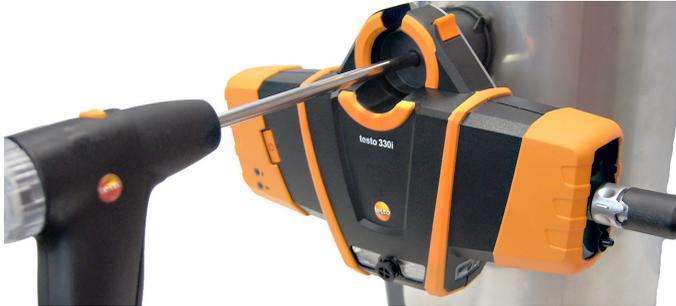
5. Abgassonde durch die Sondenhalterung in den Abgaskanal einführen.
