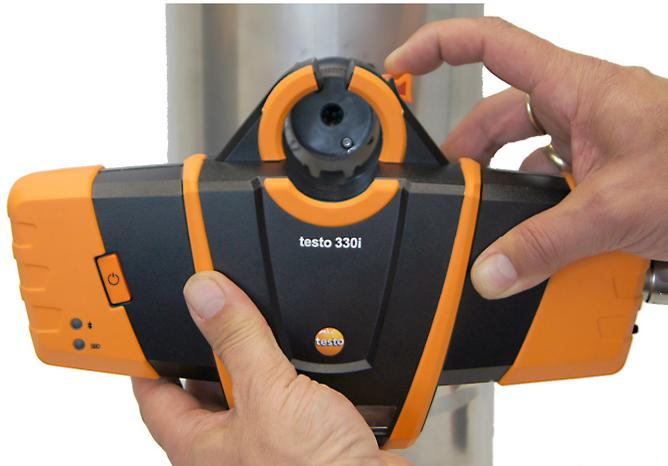
3. Messgerät bis zum Anschlag auf die Sondenhalterung schieben.
