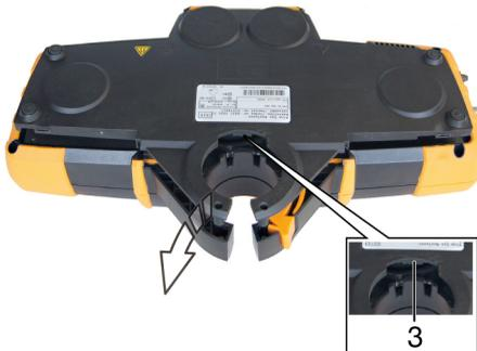
3. Den Rasthaken auslenken (3) und die Geräterückseite nach oben drücken und abheben.
