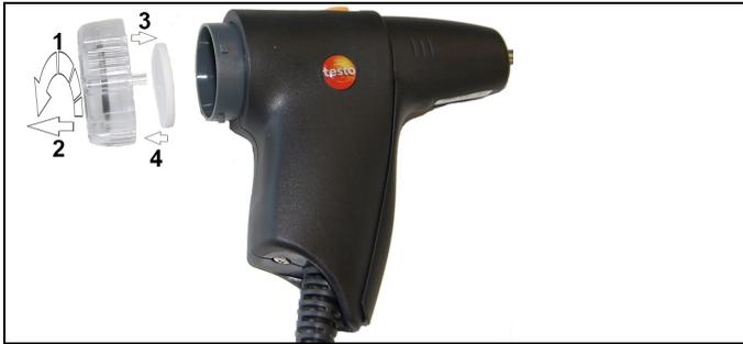
1. Filterkammer öffnen: Leichte Drehung gegen den Uhrzeigersinn (1). Filterkammer entfernen (2).
