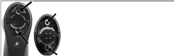
2. Abgaskanäle von Sondenmodul und Sondengriff mit Druckluft ausblasen (siehe Abbildung). Keine Bürste verwenden!
