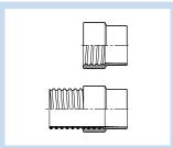
Weiche Muffe zum Aufschieben auf Stutzen oder Einschieben in Rohre, elektrisch leitfähig
