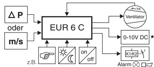
\* z.B. für EC-Motor, Klappe, Frequenzumrichter
