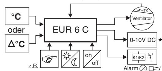
\* z.B. für EC-Motor, Klappe, Frequenzumrichter
