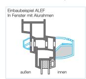
Feuchtegesteuerte Außenluft-Einströmelemente ALEF Hygro mit Volumenstromregelung/-Begrenzung zum Einbau in Fensterrahmen-/Flügel.
