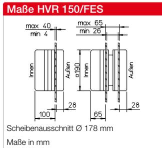
**Formschöne Fenster-Kleinventilatoren mit Förderleistungen von 80–360 m³/h.**
