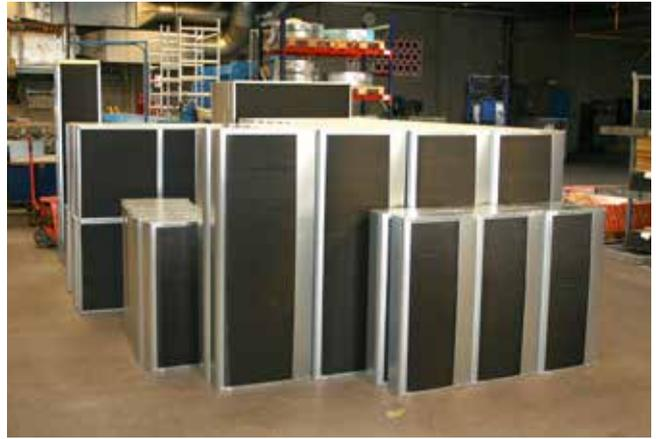
Fertig produzierte Schalldämmkulissen im Werk.
