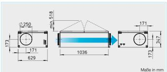
geschaltet werden. Geräuscharmer und leistungsstarker Radialventilator aus verzinktem Stahlblech. Motor-/Laufradeinheit für Service frei zugänglich. Antrieb durch energiesparenden, drehzahlsteuerbaren EC Motor mit höchstem Wirkungsgrad. Wartungsfrei, mit für die Lebensdauer geschmierten Kugellager.
