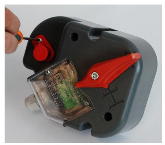
**1.2.** Entfernen Sie den Sicherungshalter, indem Sie ihn aus dem Gehäuse herausziehen.
