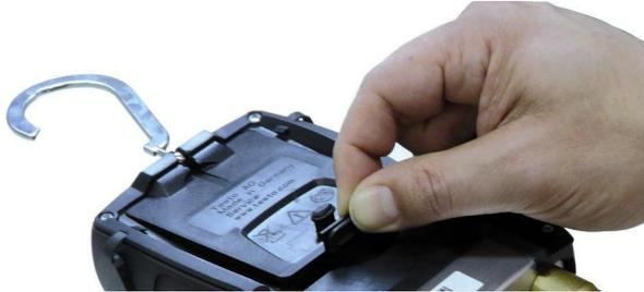
1. Die Aufhängevorrichtung ausklappen, Clip lösen und den Deckel des Batteriefachs entfernen.
