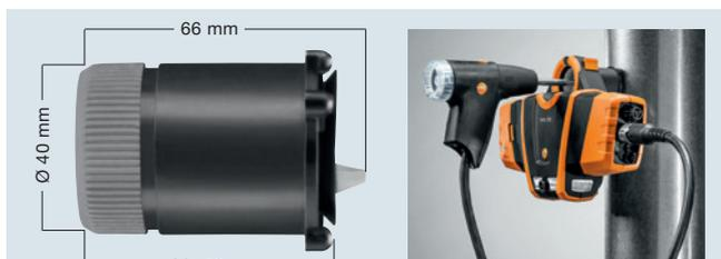
Für Messöffnungen ab Lochdurchmesser 10 mm, Abgasrohre mit Wanddicke bis zu 2 mm und Sondendurchmesser von 8 mm. Max. Oberflächentemperatur an der Messöffnung: 140 °C, Gewicht: 114 g.
