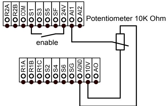
**TECO Frequenzumformer - Programmieranweisung / Parametereinstellung:**
