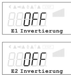
Werkseitig ist die Invertierung der Eingänge auf “OFF” sobald Eingang aktiviert (Signal: 0 - 10 V, 0 - 20 mA, 4 - 20 mA).
