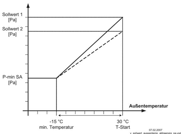
Bei Betrieb als Druckregelgerät kann eine Außentemperaturkompensation aktiviert werden (Sensoranschluss an "E2"= "Analog In 2"). Der eingestellte und aktive "Sollwert 1" bzw "Sollwert 2" wird durch diese Funktion automatisch proportional zur gemessenen Außentemperatur verändert (Info: "Sollwert Regelung").
