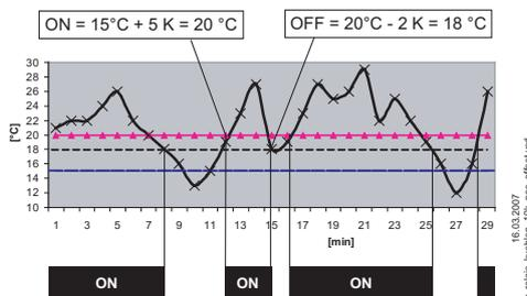
Die Kühlung bleibt bei einer Raumtemperatur über dem eingestellten Einschaltpunkt eingeschaltet. Unterschreitet die Raumtemperatur den eingestellten Einschalt- punkt der Kühlung um 2,0 K (Kelvin), wird diese ausgeschaltet. D. h. der Ausschaltpunkt liegt um den Hysterese- wert unter dem Einschaltpunkt.
