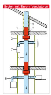
Gemäß Bauvorschrift müssen Lüftungsleitungen, die mehr als zwei Vollgeschosse vertikal durchqueren, gegen Feuer und Rauch gesichert sein. Traditionell wurde dieser Anforderung durch Platzierung der Lüftungsleitung in einem feuerfesten Schacht entsprochen. Damit verbunden waren: Hohe Investitionskosten, großer Raumbedarf, längere Bauzeit und vor allem der Aufwand von zwei Schächten (Trennung zwischen Installationsschacht mit Mischbelegung und Lüftungsschacht).
