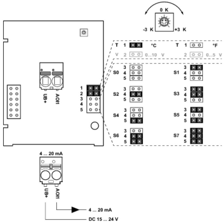
Die Messbereichsumstellung erfolgt durch Umstecken der Kurzschlussbrücken.
