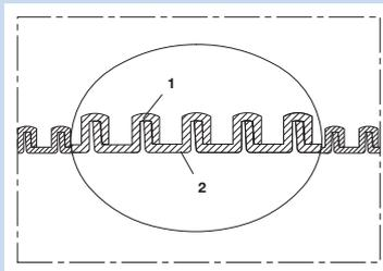
Staubsaugerschlauch, antistatisch <math>10^{11}</math> Ohm
