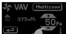
**Hinweis:** Mit Konstantdruck ist der statische Druck im Kanalnetz gemeint. Bei Veränderungen des Druckes im Kanalnetz (z.B. durch Schließen oder Öffnen von Klappen) wird der eingestellte Konstantdruck (Soll-Wert) durch Regulierung des Luftdurchsatzes (Reduktion oder Erhöhung der Drehzahl des Ventilators) erreicht.
