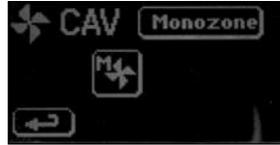
**Lüftungsmodus: Monozone / CAV****= Betrieb des Lüftungsgerätes im Konstantvolumenstrom-Modus****Manuell:**
