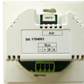
Der Anschluss eines kabelgebundenen, externen Sensors erfolgt an der RS 485-Schnittstelle der RLS 45 O/K-Steuerung (max. 3 Sensoren pro Steuerung).
